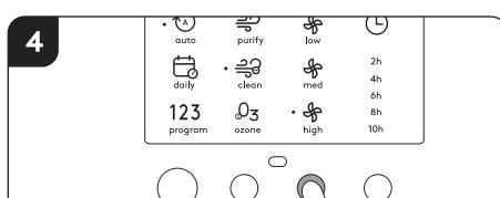
Carregue para ajustar a velocidade do ventilador
